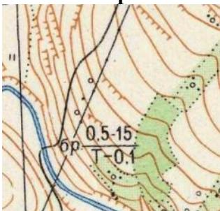
Бревно длиной 15 метров, диаметром – 0.5 метра, сделано из Тополя, высота над уровнем реки 0.1 м.
